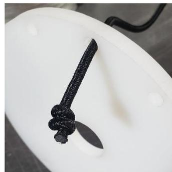
Quando a antena estiver completa, você pode puxar com força o nó da rolha, acima da placa e amarrar novamente o nó para uma antena muito segura e tensionada.
