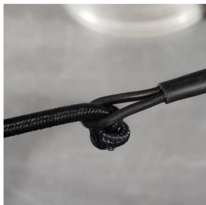
Todo os elementos devem ser fixados com uma corda extremidade do elemento (meia-volta) e o próximo espaçador de plástico disponível de forma a criar uma tensão no fio elemento.
